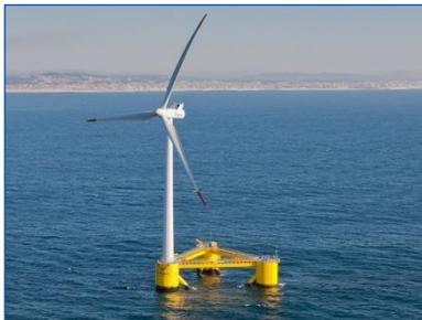
Eolienne Windfloat (source : Principle Power)
